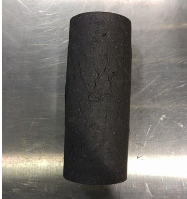
Figure 4.16 : Échantillon d'anode de carbone fissuré et testé dans sa phase molle (entre 120°C et 400°C) lors d'un essai de compression uniaxiale à chaud.
