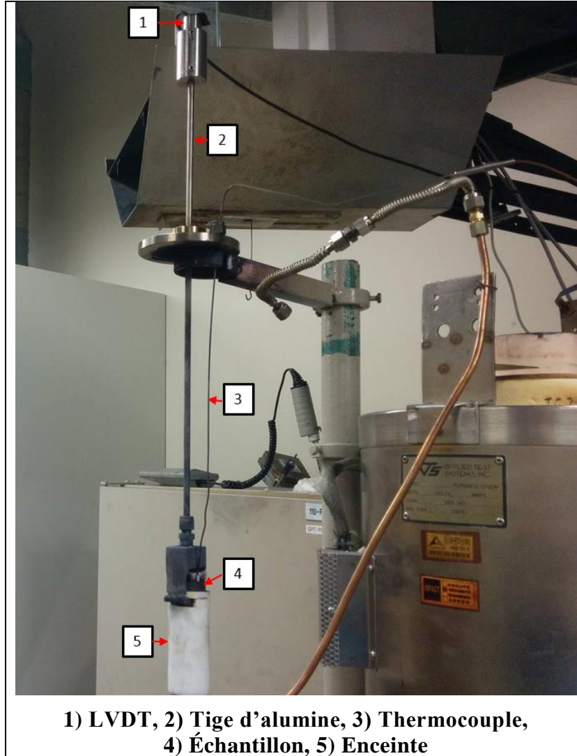
Figure 3.6 : Montage de dilatométrie.
