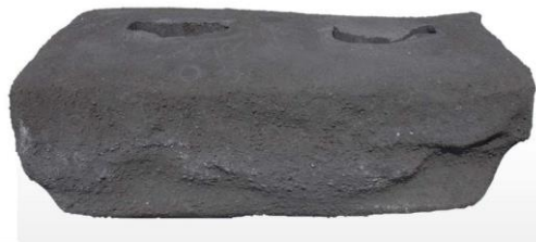
Figure 1.6 : Anode sévèrement attaquée par le CO 2 [10].
